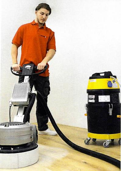
**La machine avec plateau à 3 disques**
